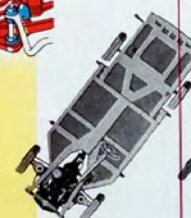
Rahmenbodenkonstruktion mit geschlossenem Mitteltrunnel und Gerippe aus kastenförmigen Trägern
