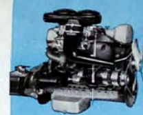
3 Ltr. — 6 Zylinder, 125 PS, 4500 U/min. Hochleistungsmotor, oben liegende Nockenwelle. 2 Mehrstufenvergaser mit automatischer Startvorrichtung
