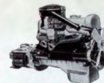
Motor: 2,2 Ltr. 6-Zylinder-Kurzhubmotor 85 PS, 4800 U/min. — Doppelstufenvergaser
