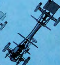
X-förmiger Ovalrohrrahmen mit hohem Profil, mit dem Karosserieboden verschraubt
